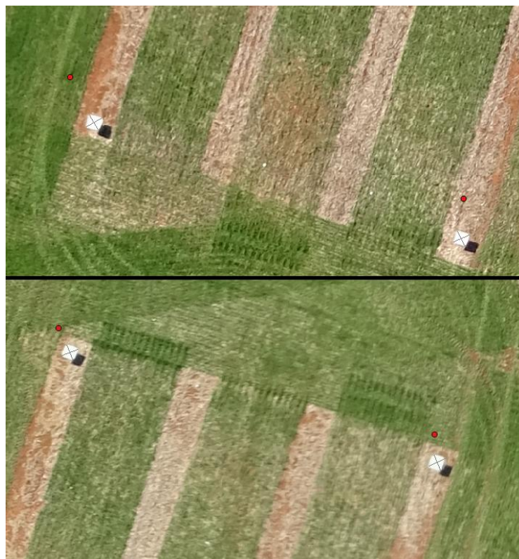
Figura 4. Demonstração do erro de georreferenciamento (tratamento PIX0)
