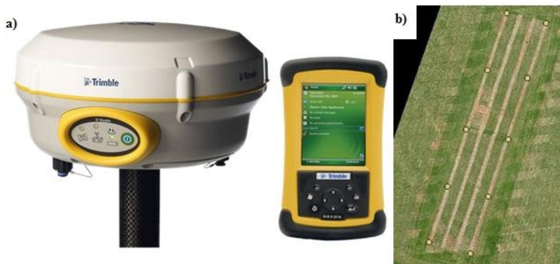
Figura 3. a) GPS Trimble R4. b) Disposição dos GCPs na área experimental
