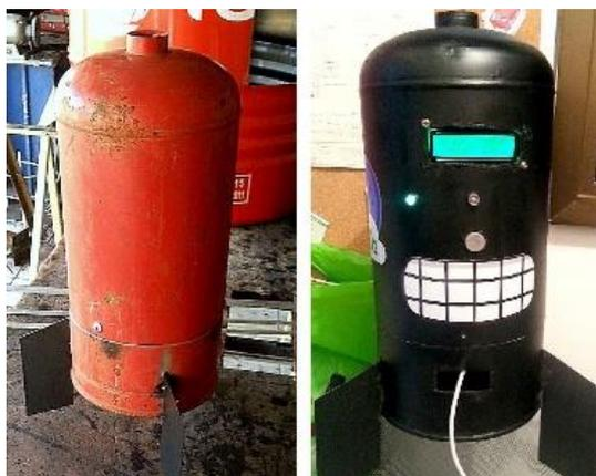
Figura 11. Etapa inicial e final da construção do dispositivo Brezobomba.
